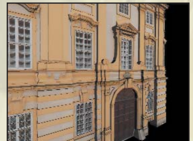
Dai punti alle superfici, mesh texturizzata ad alta risoluzione della stessa facciata.
